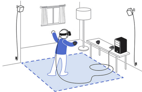
Figura 3 – Área de cobertura das Base Stations SteamVR 2.0.
