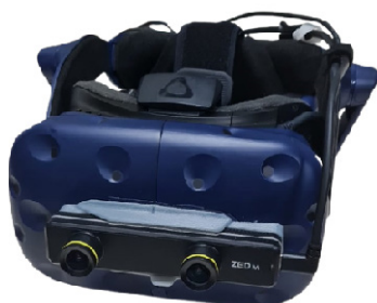
Figura 2 – HMD HTC Vive Pro 2 com Stereolabs Zed Mini acoplada.
