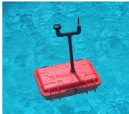
Figura 5 – Conjunto de pseudo boya y pequeño mástil que soporta las antenas GPS (izquierda) y LoRa (derecha).
