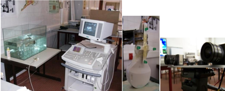
Figura 6. À esquerda, aparato experimental para recolha de imagens ecográficas. Ao centro, o pormenor dos marcadores acoplados à sonda. Na direita, sistema de visão stereo.
