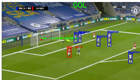
Figura 4 – Muestra el dibujo de la detección de las líneas de demarcación del campo, la posición de la pelota con el seguimiento y la velocidad. También etiqueta los equipos de cada jugador y muestra el resultado de la verificación del evento de gol.
